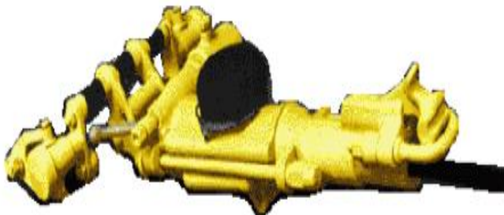
5.1 – сурет – ПП-50В1 перфораторы
